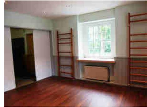
Der wurde Toberaum gründlich renoviert und energetisch verbessert: ein neuer Bodenbelag, der auch für mehr Fußwärme sorgt, die Fensterbänke wurden durch stabile Holzfensterbänke ersetzt, eine neue abgehängte und gedämmte Decke mit integrierter Beleuchtung, sowie ein neuer Anstrich.
